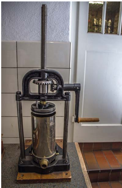
Mit diesem Gerät werden seit hundert Jahren die Tuben abgefüllt (Foto: Georg Infanger).
